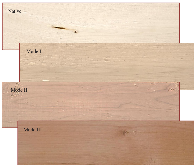
Fig. 3. View of birch wood before and after heat treatment by individual modes. Obr. 3. Pohľad na brezové drevo pred a po tepelnom spracovaní jednotlivými režimami.
